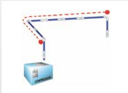
Ce type de réseau n'est recommandé que pour des consommations en dessous de 1200 NL/min.
