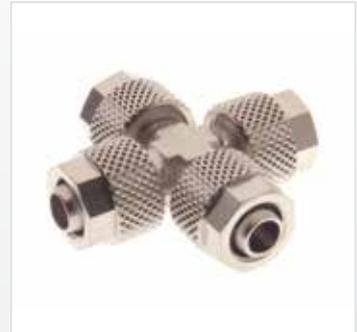
Les raccords de **la série 1000** sont des raccords de compression "push on" tout en laiton pour se raccorder en toute sécurité directement avec des tubes en thermoplastiques pour les applications pneumatiques et tous fluides. L'étanchéité est directe sur le tube et la connexion est facilitée grâce à la forme particulière de la coiffe. Le six pans de l'écrou de serrage est toujours sur l'extrémité pour faciliter le montage.
